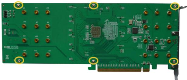
**注意:** 在将铝盖重新固定到 SSD7540 之前，确保铝盖与控制器板 (PCB) 正确对齐，并与散热垫完全接触。如果盖子安
